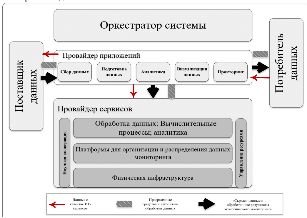
Рис. 1. Архитектура распределенной инфраструктуры анализа больших данных экологического мониторинга, на основе стандарта NIST Big Data Reference Model
